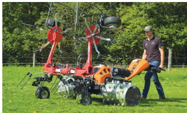
In Transportstellung sind die inneren Kreiselräder frei beweglich und ermöglichen eine breitere Spur.
